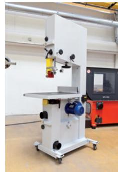
3 kW, kpl. mit APA-Führung oben + unten, Not-Aus Schalter.
