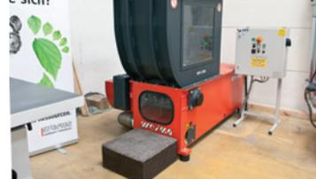
18,5 kW, 2-te Messerreihe, Logspacer (freischneidender Trichter).
