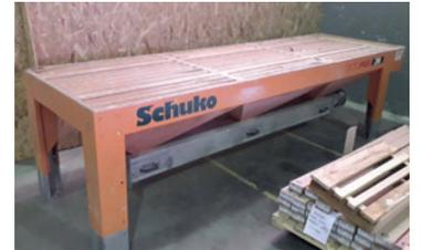
Abgesaugter Arbeitstisch f. den stationären Anschluss an die Absaugung, 200 mm Ø, LxB 3280 x 1000 mm, Arbeitsfläche 3000 x 1000 mm, verstellbare Tischhöhe 700-1000 mm, 3000 m³/h Volumenstrom, - Maschinenstandort - ZAGREB (HR).
