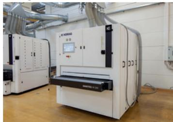
Breitbandschleifmaschine mit automatischer Werkstückdickenmessung, Werkstückerkennung 25, Einlauf Tisch, Vakuumtisch 3 kW, ATA 2 Auflagetisch klappbar, R Aggregat mit 15 kW - 20m/s, C Aggregat mit 15 kW - 2-18 m/s, Wechse Bürstenaggregat 5,5 kW, SBAW Wechselbürste Anderlon K 80, Finish-Bürste 0,75 kW (Rosshaar) 0,75 kW, Ansteuerung der Absaugzieher.
