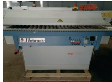
BJ 08, Anleimen/Kappen/Radius-Fasefräsen, max. ca. 3 mm Kantendicke, max. ca. 50 mm Werkstückhöhe, ca. 10 m/min Vorschubgeschwindigkeit, in ca. 5 min. Betriebsbereit, ca. 6,5 kW Leistungsaufnahme, elekt. Anschluss: 400 V, 3Ph, 50 Hz, 900 mm Arbeitstischhöhe, 100 mm Absaugstutzen-Ø, Preisstellung im überholten Zustand - 6 Monate Gewährleistung. !ACHTUNG - MASCHINENSTANDORT - SLOWAKEI!
