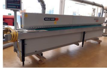
BJ 99, Fügen, Anleimen, Kappen, Fräsen – Bündig, Fräsen-Radius, Profiziehklinge, Eckenkopierer, Flächenziehen, Schwabbeln, max. 8 mm Anleimerstärke, Preisstellung im überholten Zustand - 6 Monate Gewährleistung.
