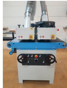
Bürstendrehzahlregelung mit Inverter 5,5 kW für 1. Bürste und 2. Bürste, Motorstärke 5,5 kW, oszillierende Vorrichtung für 1. Bürste und 2. Bürste, Bürste aus Tynex K 46, Bürste aus Tynex K 60.
