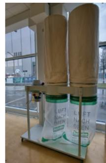
BJ 2020, Absaugsystem Alfa 2 3HP CE - mit Baumwollfilter, 2,2 kW, 200 mm Anschluss-Ø, 3.000 m³/h Leistung, Absaugsystem für Fräs-, Hobel- und Sägespäne (kein Staub). Aufbau aus Stahl. Schnellspanverschlüsse für Filter und Spänesack. "Achtung: dieses Gerät darf nur
