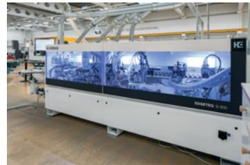
Verlängerung Einlauflineal, Schnittstelle Loopteq 0-200, Edition PAKET, Kettenbahn-Zentralschmierung automatisch, Elektronische Höhenverstellung Oberdruck, Trennmittel, Werkstückvorwärmung IR-Strahler, QA 65 Auftragseinheit, Automatischer Kanteneinzug, Mehrstufen-Frässaggregat inkl. 3 Rollentastung, Formfräsaggregat 1x 0,35 kW inkl. Konstruktionsböden, Mehrstufen-Ziehklagenaggregat MZ40, Leimfugenziehklinge, Reinigungsmittel, Schwabbelaggregat 2 Motoren, Homag Powertouch 24", Beleuchtung.
