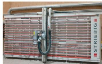
BJ 03, 5,5 kW, Schnittbereich 4300 x 2200 (2100 xHhor) x 80 mm, 303 mm Sägeblatt- Ø, 4750 U/min Sägeblatt-Drehzahl, 3x400 V/50 Hz Netzanschluss, Abmessungen LxHxT: 6451 x 2901 x 1661 mm. Preisstellung im überholten Zustand - 6 Monate Gewährleistung.
