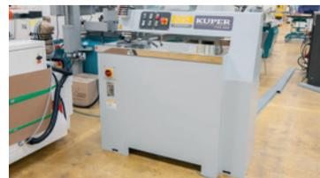
Vorteile auf einen Blick: Diskusscheiben mit Toleranzausgleichsmechanismus, Standardheizungssystem der Industriemaschinen, Stillstandsregulierung, elektrisch gesteuerte Faden-Abreirolle, Startfunktion über Lichttaster.
