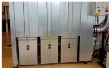
Prüfzeichen H2+H3 / BG HO 123026, Motorleistung 3,7 kW, 400 Volt, 50 Hz, 3 Ph, Absauganschluss 200 mm, Nennvolumenstrom (bei 20m/sec.), 2.260 m³/h, Volumenstrom 2.495 m³/h, Unterdruck 2.800 Pa, Filterfläche 14,5 m², Filterregeneration elektromotorisch, Schalldruckpegel 77 dB(A).
