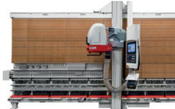
Optimierungssoftware ExpertCut CON, Vorritz-Sägeaggregat VSA (stufenlos), Spannflansch ProLock, Kleinteileauflage aus Aluminium (2 Elemente), Set für freistehende Montage.
