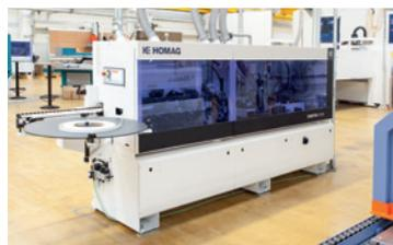
Kantestärke bis 3 mm, Werkstückstärke 8 – 40 mm, Komplettbearbeitung vom Fügefräsaggregat über Anleimen, Kappen, Bündig-Radius-Fasefräsen, Eckenbearbeitung bis hin zur Profilziehklinge, Leimfugenziehklinge, mit Easytouch-Steuerung.
