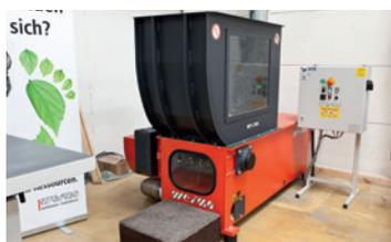
Zum Verarbeiten zu Brennspänen von allen Arten von Holzwerkstoffen, mit 18,5 kW Antriebsleistung,
