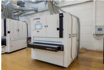
Automatische Werkstückdickenmessung, Werkstückerkennung 25, Einlauftisch, geteilter Vakuumtisch 3 kW, Auflagetisch klappbar, C Aggregat mit 15 kW – 18 m/s, H Aggregat mit 15 kW - 2-14 m/s, Wechsel-Bürstenaggregat 5,5 kW, SBAW Wechselbürste Anderlon K 80, Finish-Bürste 0,75 kW (Rosshaar), Beleuchtung, Ansteuerung der Absaugzieher.
