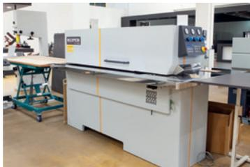
Mit integriertem Beleimaggregat zur Verklebung von Furnierstreifen in einer Dicke von ca. 0,35 bis 2,5 mm, Kompaktkühlung, Optionspaket Starkfurnier für Furniere bis 5,0 mm Dicke.
