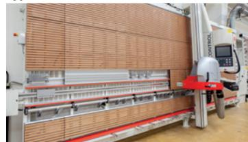
STRIEBIG ExpertCut CON, Vorritz-Sägeaggregat VSA (stufenlos), Spannflansch ProLock, Klein-teilaufgabe aus Aluminium (2 Elemente), Set für freistehende Montage.
