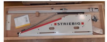
WSG 025.820. Das WSG Winkelschnittgerät hält das einmal eingestellte Maß in allen Winkeleinstellungen exakt. Es ist auf allen Striebig-Modellen einsetzbar und kann an allen Schnittpunkten montiert werden. Eine spiegelverkehrte Montage (rechts vom Schnittpunkt) ist ebenfalls möglich.
