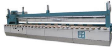
15 kW, 160 mm Schnitthöhe, Positioniersteuerung/ Kettenmasssteuerung, 30 mW Laser-Richtstrahlgerät montiert an Längsschnitt-Kreissäge, Niederhaltebalken im Absaugbalken montiert auf einer Länge von 3 m, Metall-Auflagen aufgeteilt mit Kugelrollen (4 Stk.).
