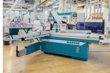
1100 mm Schnittbreite, Elektromot. Pos. d. Parallelschlags, Motorstärke 7,5 kW, Parallelogrammquertisch, Längenschlag analog mit 2-Punkt-Anlage und zwei Anschlagelementen, Doppels. Gehrungsanschlag MitreX analog.
