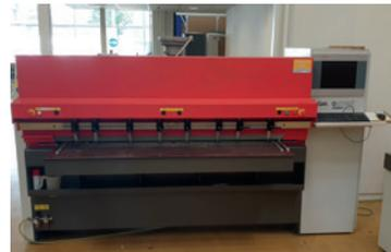
BJ 05, Automatikstart der Maschine, elektronisches Leimüberwachungssystem GIC, 4 vertikale Spannzylinder 10° zusätzlich, Anschlagssystem Winkelfehlerausgleich, Gehrungsanschlag 45°, Sensorabfrage Gehrungsanschlag, Barcodelaser, Software Netzwerkanbindung TC Programmiersystem, vorführbereit\*.
