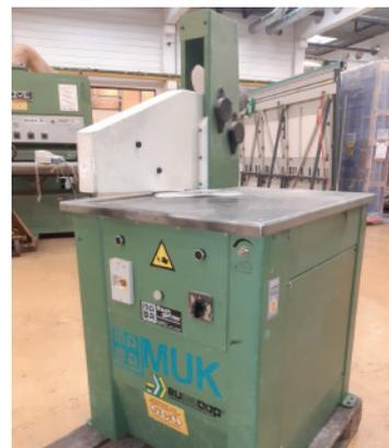
Untertischkappsäge ohne Rollenbahnen, 450 - 500 mm Sägeblatt-Ø, Absaugstutzen: 2 x 120 mm,
