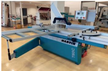
BJ 2020, 2-Achsen-Vorritzaggregat, elektrisch, Vorritzer-Beleuchtung SafeLight (markiert den Gefahrenbereich des Vorritzers während des Betriebes durch ein aufmerksamkeitserhöhendes Licht), MitreX Doppelgehrungsanschlag, Zweite Auflage für große Platten und als Auflage beim Arbeiten mit dem Gehrungslinial, Parallelschneidhilfe einsetzbar, Vordertisch, abklappbare Tischfläche ca. 600 x 350 mm, VORFÜHRMASCHINE - NEUWERTIG war ca. 1 Monat im Einsatz Preisstellung mit 12 Monaten Gewährleistung!
