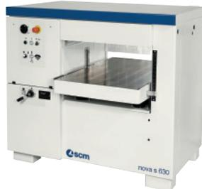
Motorleistung 9 kW Hz50, inkl. automatischem Stern dreieckanlauf, Xylent Spiralhobelwelle mit 3 Reihen Schneiden/630, Xylent Wartungskit.
