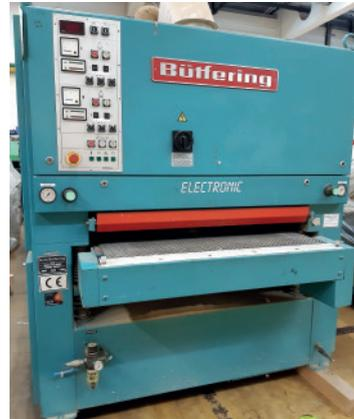
BJ 96, 1100 mm Schleifbreite, 1. Aggregat: Kombi mit Stahlwalze und Elektronikschleifschuh, 2. Aggregat: Elektronikschleifschuh, LxBxH: ca. 1.800 x 2.000 x 2.000 mm, ca. 3.000 kg.
