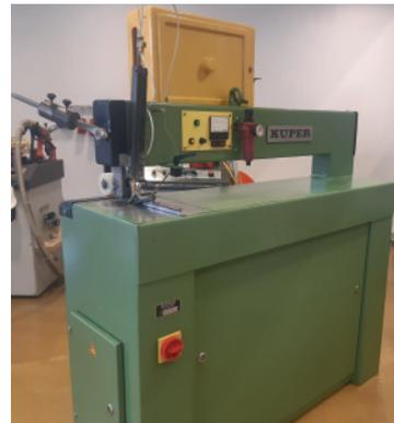
BJ 2001, 900 mm Ausladung, ca. 0,4 - 2 mm Furnierdicke, ca. 15 m/min. Vorschub, 0,18 kW Antriebsmotor, 0,5 kW Gesamtanschluss, LxBxH 1280 x 580 x 1470 mm, 166 kg. Verkauf im werkstattüberholten Zustand. Ausstellungsmaschine - vorführbereit!
